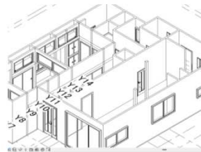
BIMによる木造住宅の改修モデルの作成とマテリアル集計
